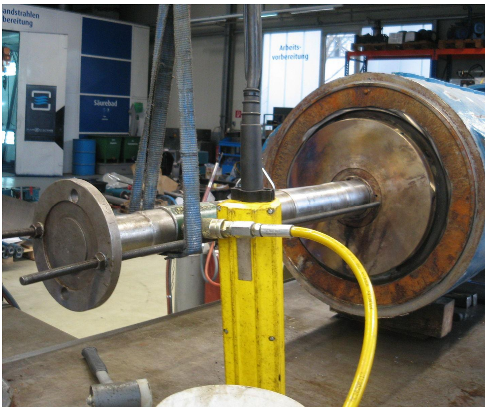
Läuferdemontage mit Hydraulikpresse
