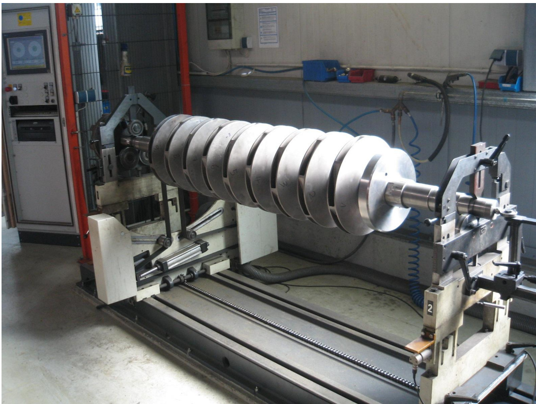
Dynamisches Auswuchten in zwei Ebenen bei einer Betriebsdrehzahl von 2900 1/min
