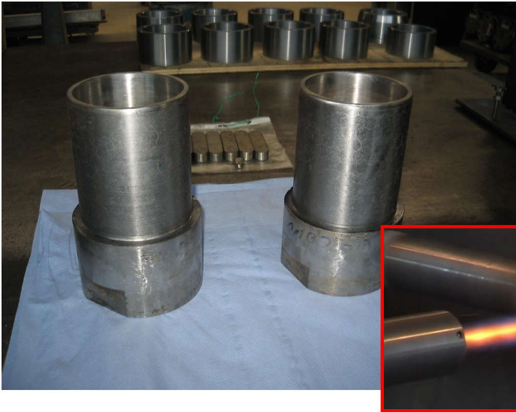
Wellenschutzhülsen durch thermisches Flamspritzverfahren aufgearbeitet
