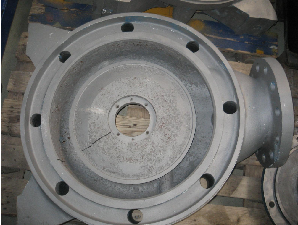
Druckgehäuse - Reinigung durch glasperlenstrahlen / sandstrahlen
