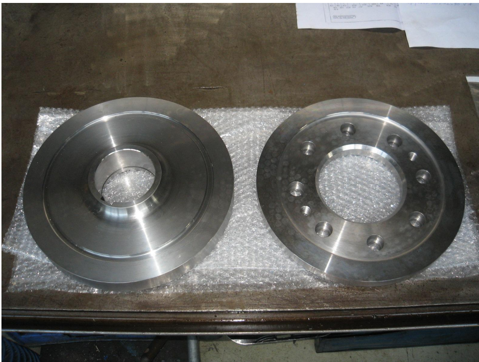
Neufertigung der Entlastungspartie
