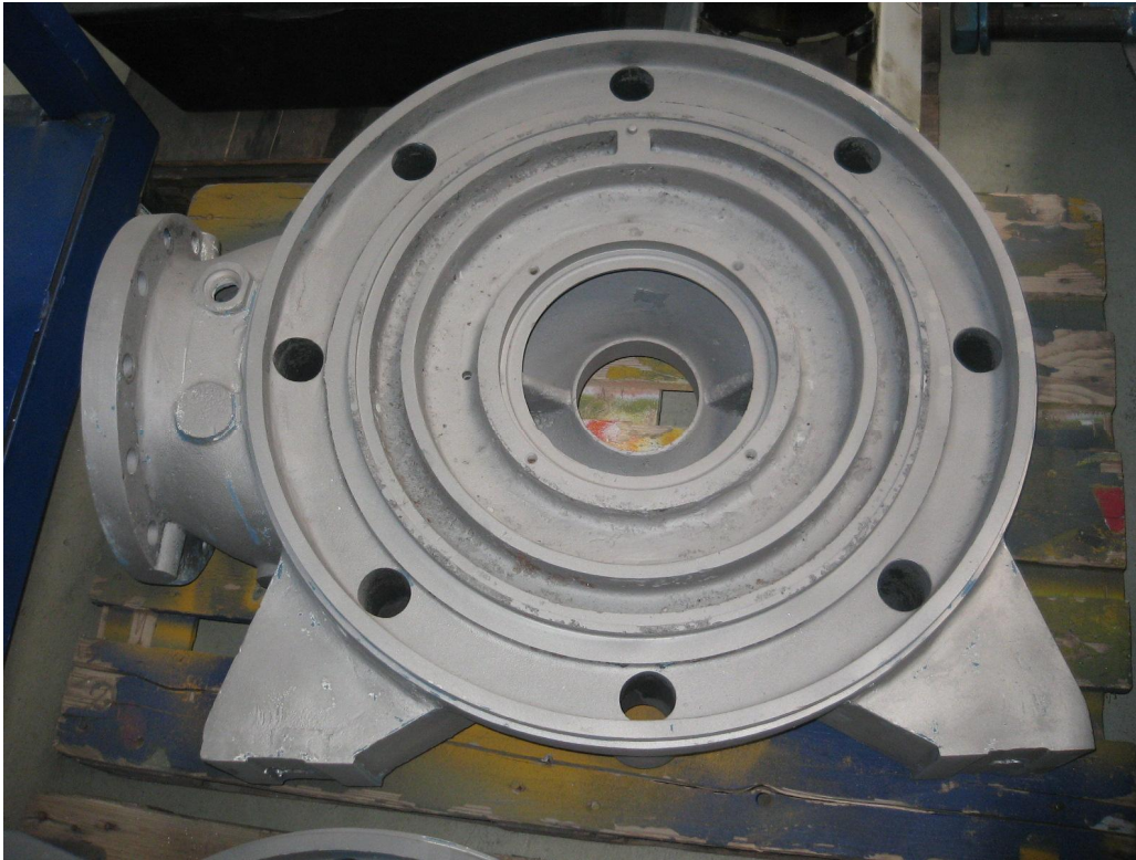
Sauggehäuse - Reinigung durch glasperlenstrahlen / sandstrahlen
