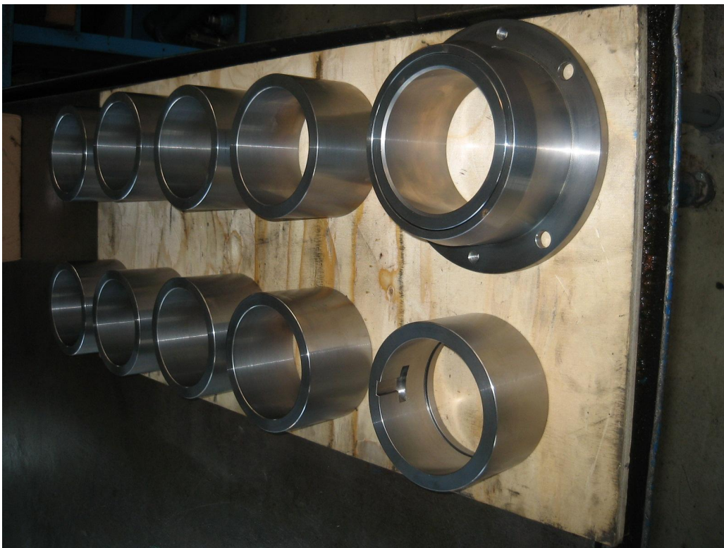
Wellenhülsen und Drosselbuchse neu gefertigt
